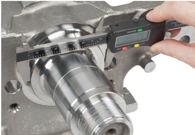
Bild 2: Um festzustellen, welcher der drei Schutzringe passt, muss der Durchmesser des Dichtungssitzes gemessen werden
