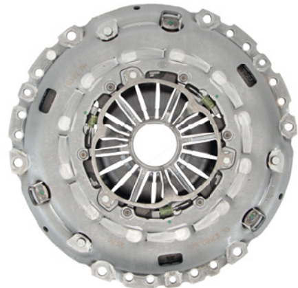
Bild 2: Druckplatte des RepSets 625 3212 09 (für Fahrzeuge ab Baujahr)
